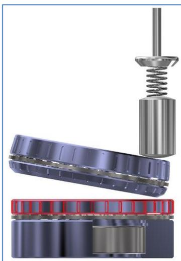
Am Beispiel einer Spiralfeder, die zwischen einem Kolben (unten) und einem Ventil (oben) eingeklemmt ist und deren Länge durch eine rotierende Taumelscheibe verändert wird, wird das Vorgehen erläutert:
